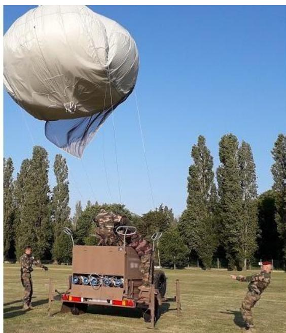
Prévu pour être déployé en France comme à l'étranger, le ballon captif sera installé sur une remorque. Afin de pouvoir accompagner un détachement à l'extérieur d'une emprise, le système doit être rustique et mis en œuvre de manière autonome par un équipage réduit, non spécialiste des systèmes aériens. Sa disponibilité doit également rester élevée, malgré des conditions environnementales difficiles et l'absence d'infrastructure dédiée pour le protéger.
